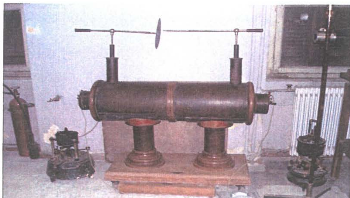
Μεγάλο πηνίο Ruhmkorff και εκατέρωθεν δύο ηλεκτρικοί διακόπτες υδραργύρου
